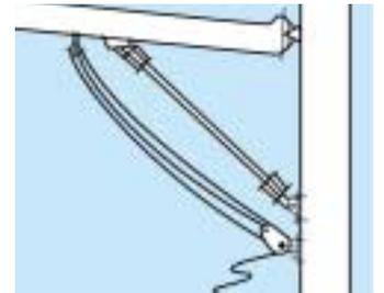
Unter dem Druck des Grossbaumes oder des Baumniederholers werden die Boomstrut-Stäbe zusammengedrückt und wirken als Dämpfer.
