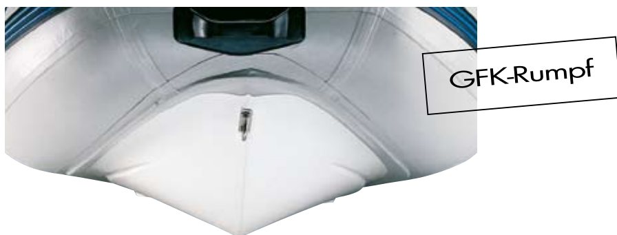
GFK-Rumpf in V-Form mit stabilisierenden, seitlichen Längskufen.
